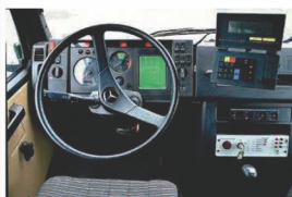
1986 A Mercedes-Benz cria o primeiro protótipo de veículo autónomo equipado com câmaras e sensores
